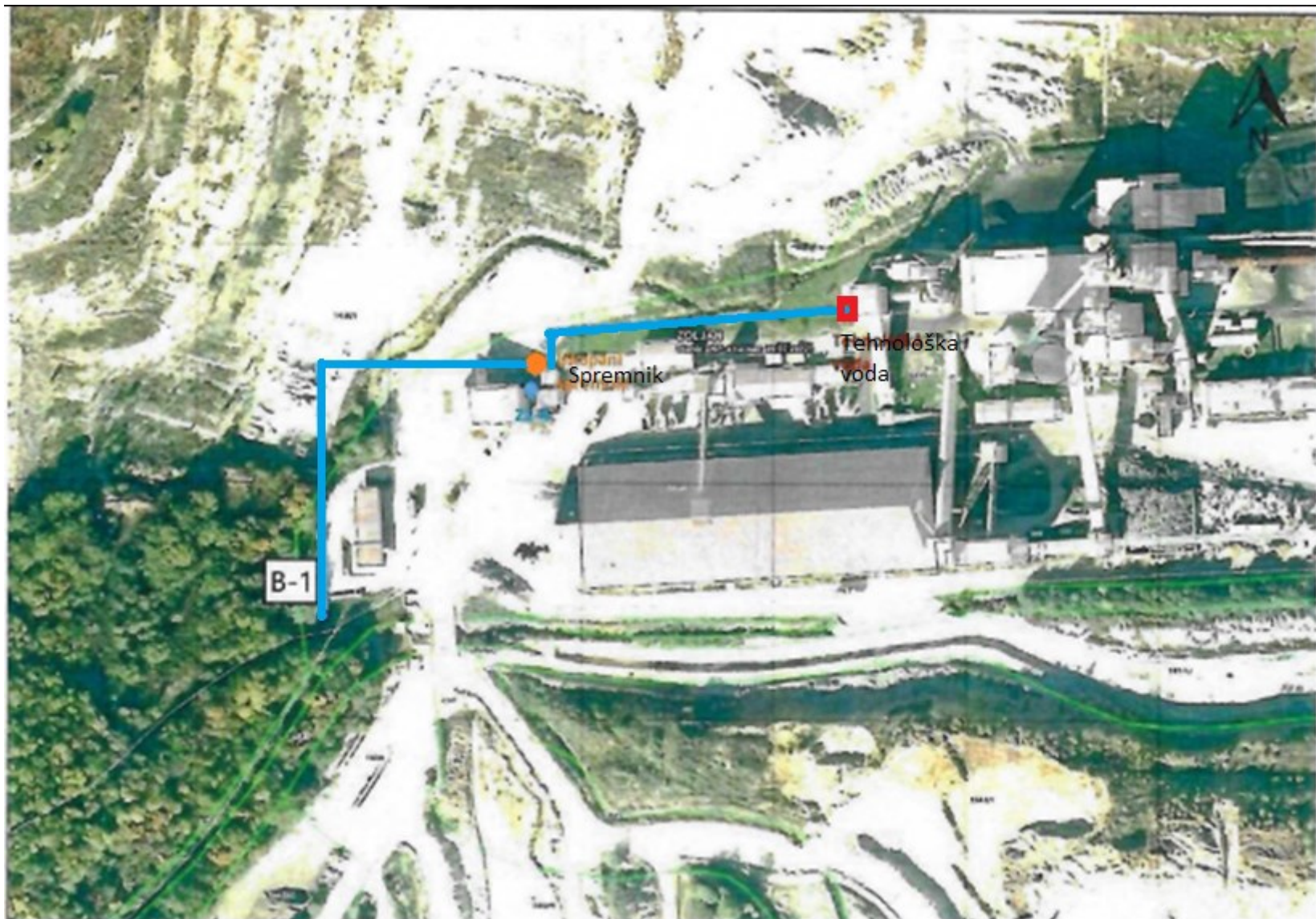
Slika 5. Prikaz trase cjevovoda od zdenca za tvornice – Izvod iz projekta
